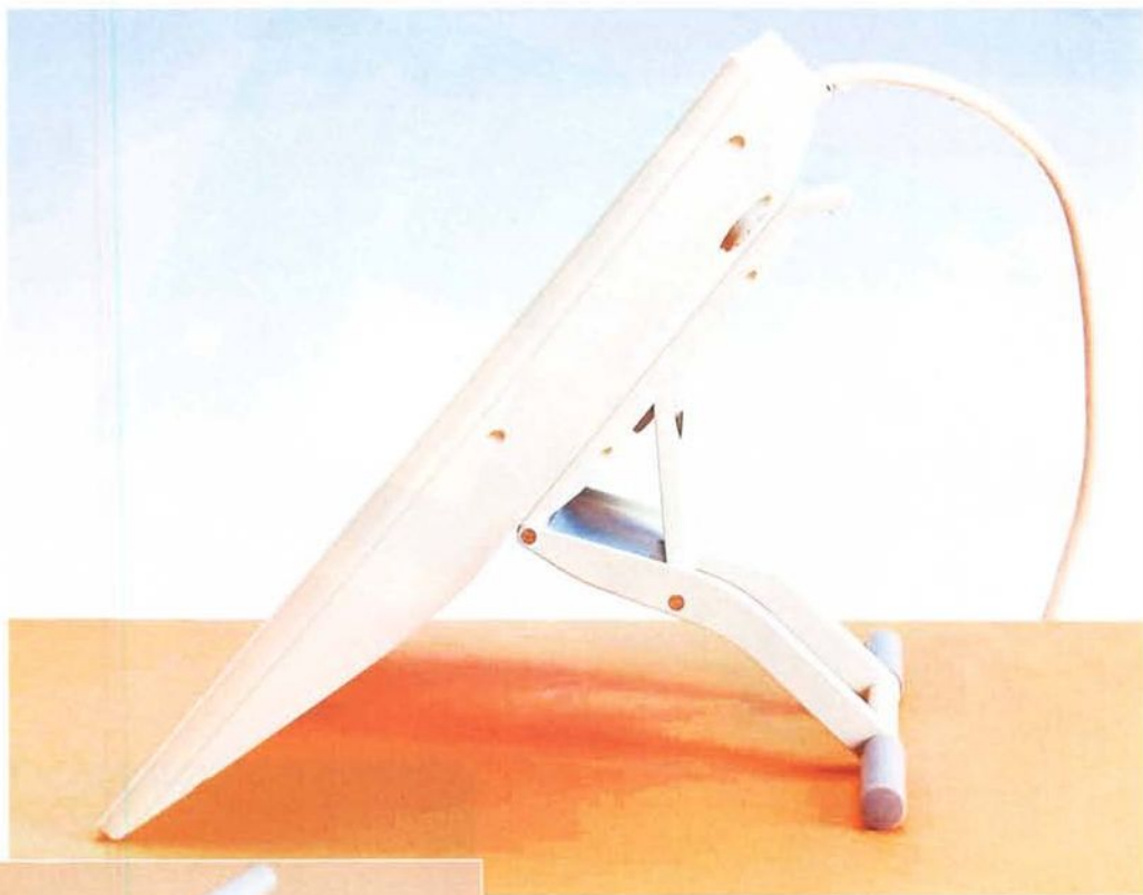
La tavoletta grafica vista di profilo; si può facilmente notare il ridotto spessore del pannello LCD.
